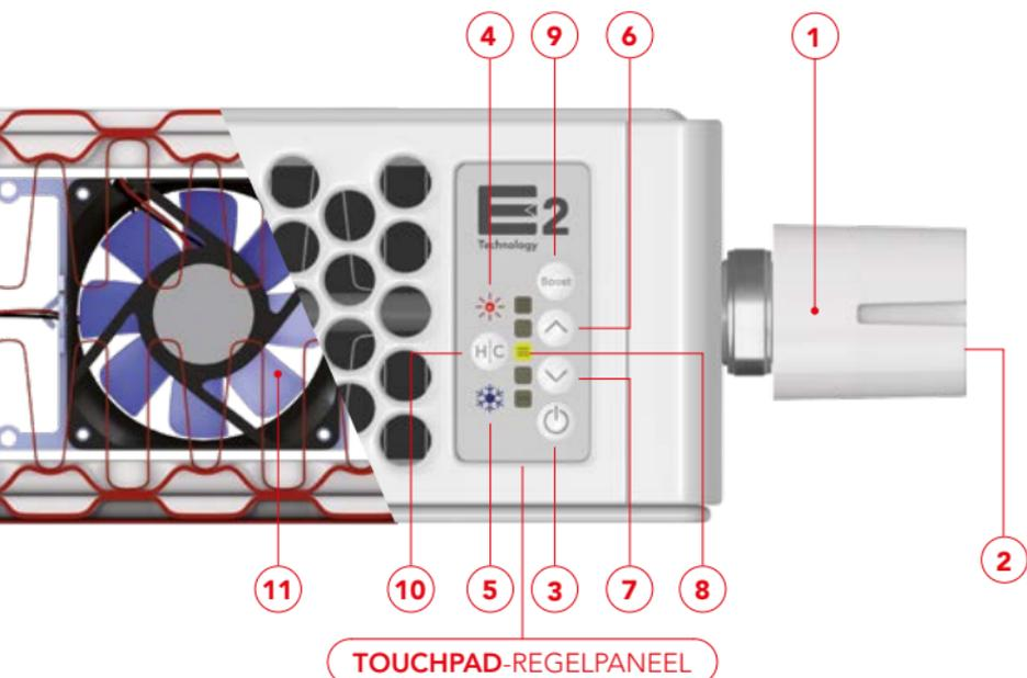
**1** Elektronische aandrijving met verbindingkabel
