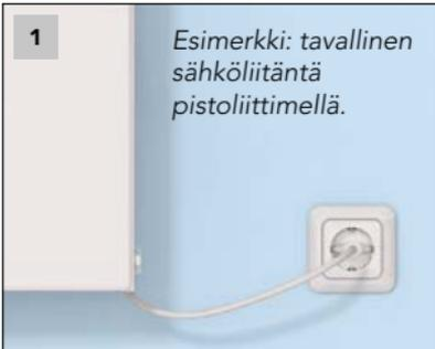
1) Kytke sen jälkeen E2-laite Euro-pistokkeen kautta sähköverkkoon tai ...
